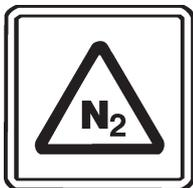
L'accumulateur ne peut être chargé qu'avec de l'azote !
