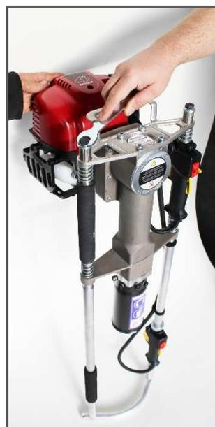
3. Enlever le carter plastique pour atteindre la connexion de la vis du câble de l'accélérateur. Utiliser la clé pour légèrement desserrer le gland du câble de l'accélérateur. Puis détacher le câble de l'accélérateur.
