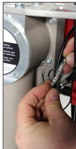
6. Faire passer le câble d'accélérateur de votre rallonge jusqu'au carburateur. Serrer le raccord vissé de l'accélérateur et du levier du carburateur et serrer le tout avec la clé. Remettre le carter plastique.
